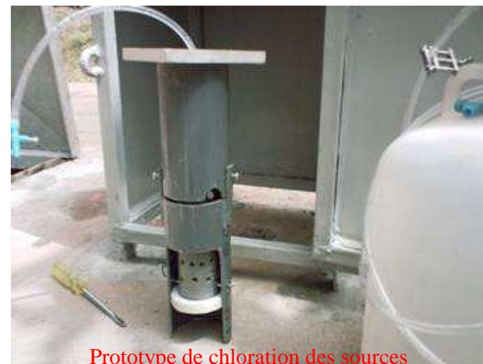
Prototypé de chloration des sources
